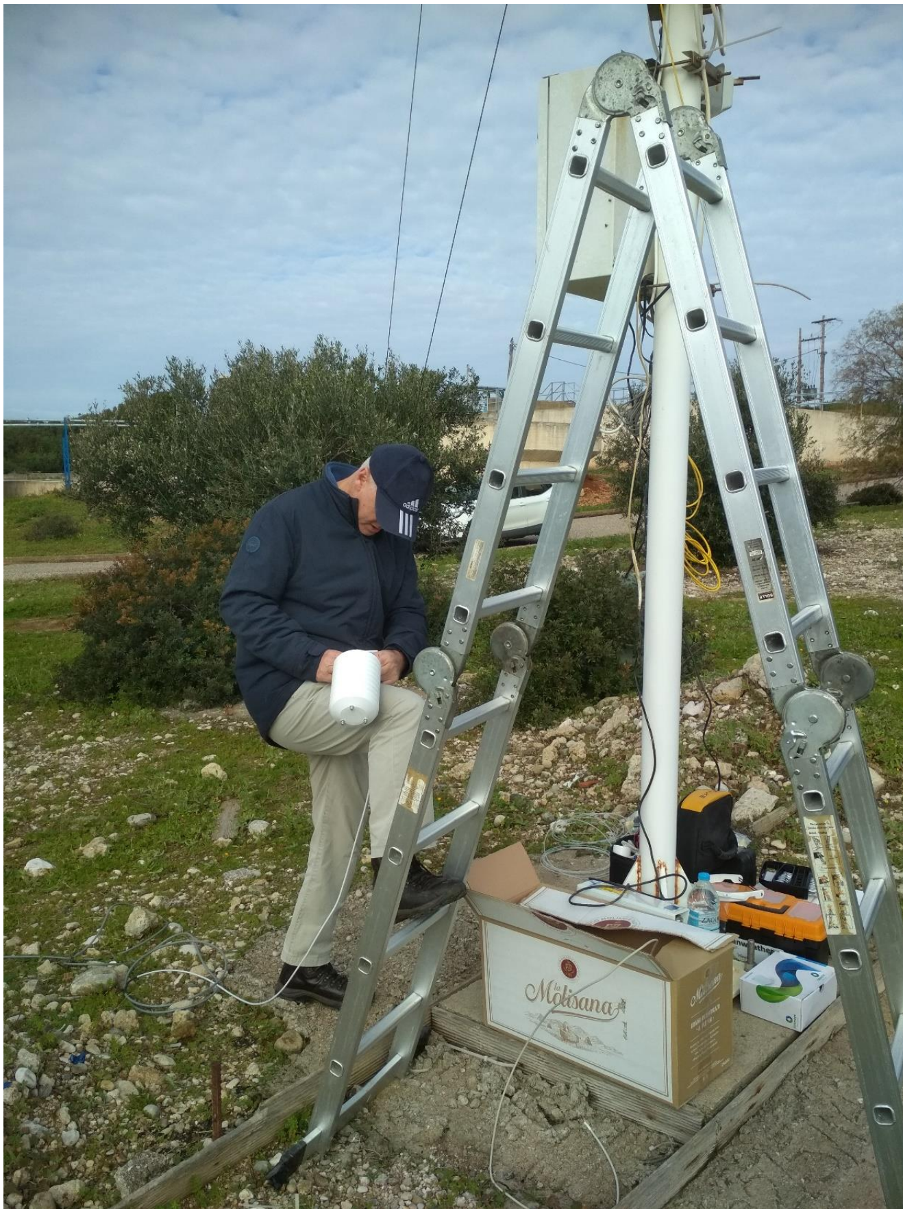
Εικόνα 1.2-5: Απο την αντικατάσταση θερμοϋγρόμετρου στον σταθμό KTL-1 στις 22/12/2021.
