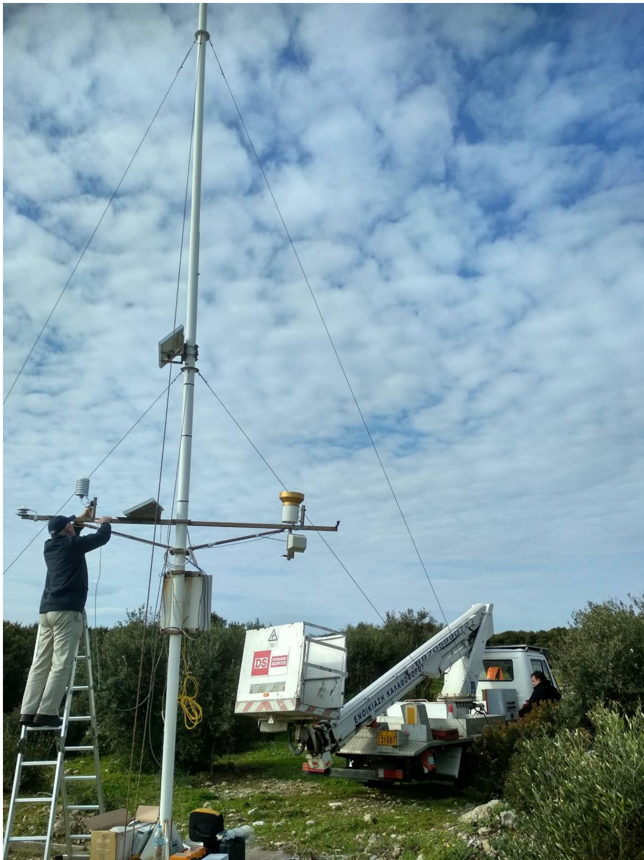
Εικόνα 1.2-4: Απο την αντικατάσταση θερμοϋγρόμετρου στον σταθμό KTL-1 στις 22/12/2021.
